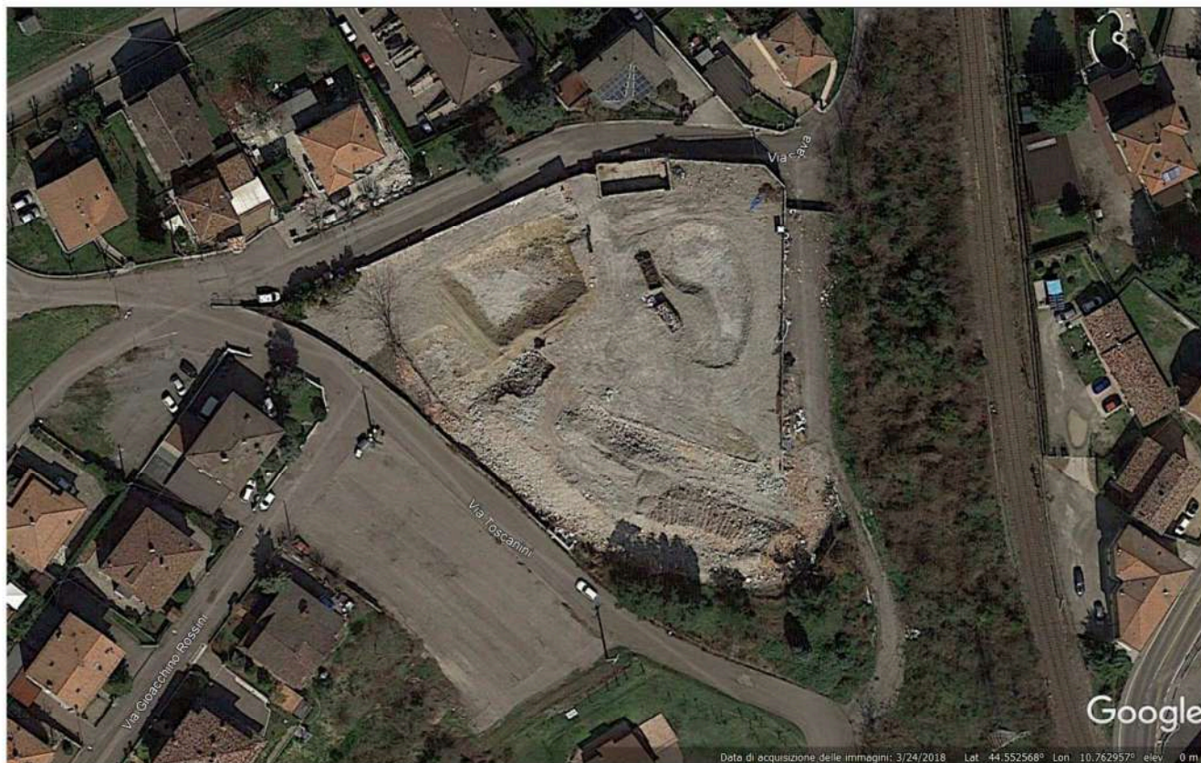
Figura 2: Dettaglio area di interesse dello stato di fatto da foto aerea tratta Google Earth del Marzo 2018. La superficie del comparto è occupata dagli scarti di demolizione del vecchio complesso in attesa di essere smaltiti.
